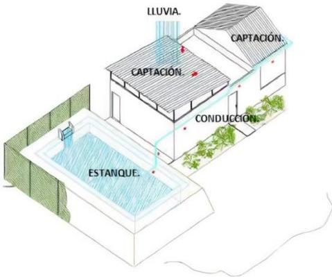
Figura 10. Sistema de captación Colpos 2 (tomado de CIDECALLI, 2008).
