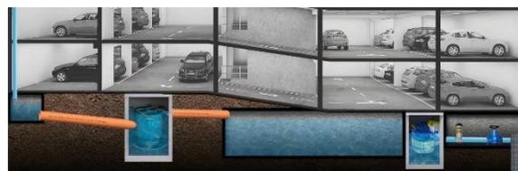
Figura 8. Esquema de infiltración a través de pozo profundo (tomado de AMSCALL, 2012).
